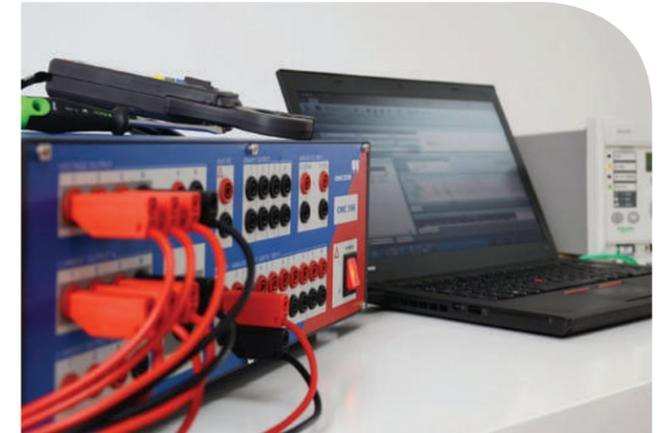
Foto 9. Equipo de pruebas a relés de protección
